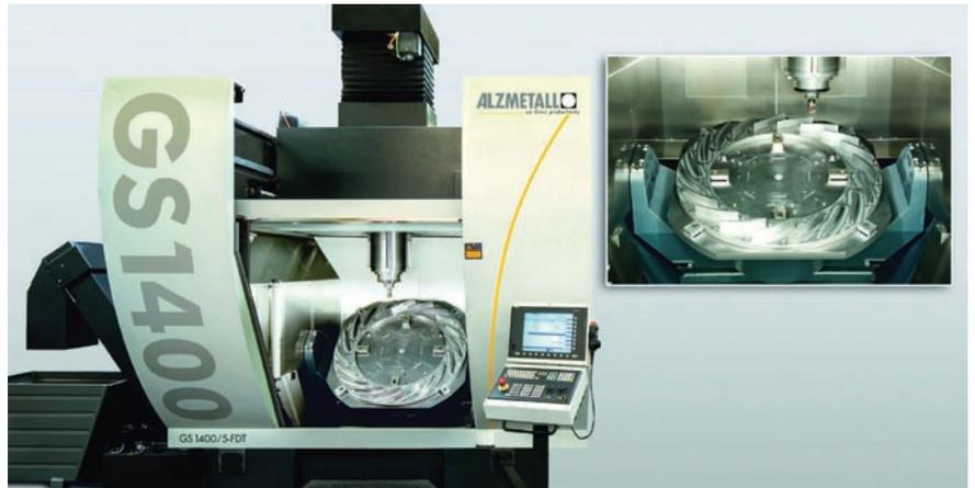
Drehen und Fräsen auf 5-Achs-Bearbeitungszentrum GS 1400/5-FDT – Produktivität durch Hybridbearbeitung in einer Aufspannung (Quelle: ALZMETALL)
